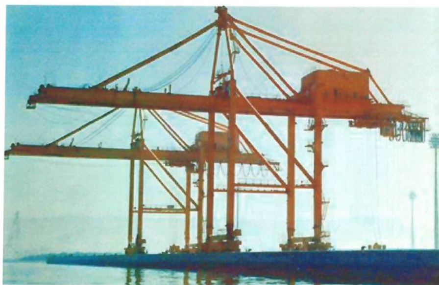
Figura 05 – Guindaste de pórtico utilizado para içamento de cargas
