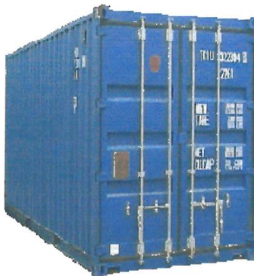
Figura 22 – recipiente empregado no transporte de cargas de grandes proporções ou numerosa
