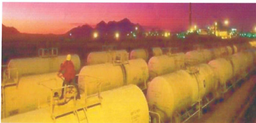
Figura 15 – Transporte de carga perigosa de grande porte por trilho
